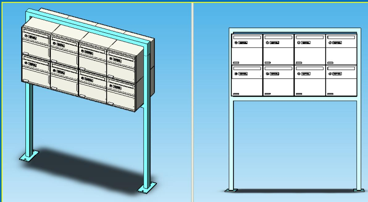
**TYPE P 740 : TUBE INOX 40/60 SOUS ET SUR LES BOÎTES AVEC 2 PIEDS À SCELLER**
